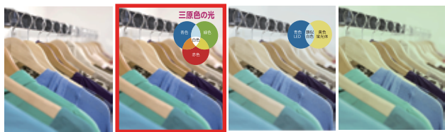
自然光 Ra100前後 無電極 Ra80 (青・緑・赤の3波長型) LED Ra70 (青色LED+黄色蛍光体) 水銀灯 Ra40前後
